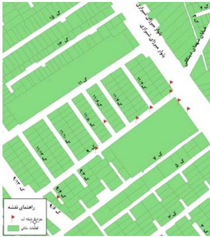
شکل ۷. نقشه پراکندگی حوادث شبکه آب در یک معبر شهر شیراز
