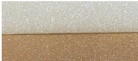
شکل ۳: تغییر رنگ قبل و بعد از پوشش دهی با نانوذرات نقره
