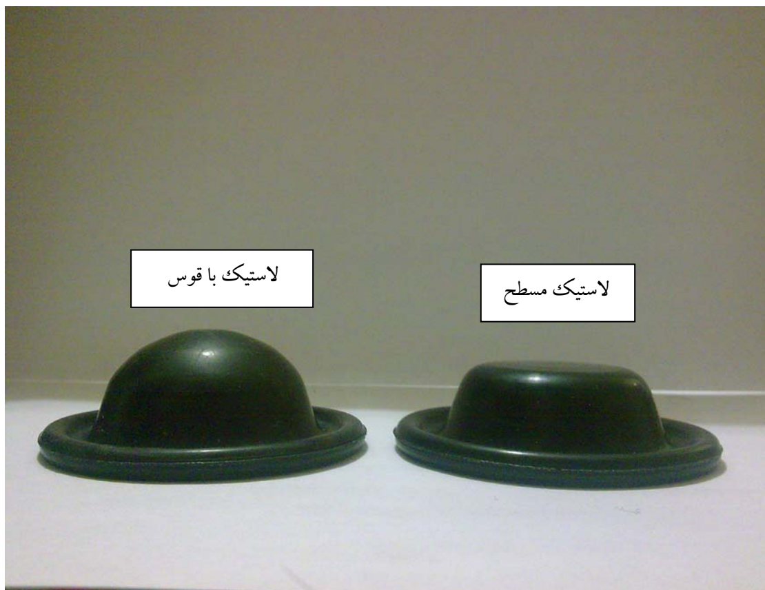
شکل ۴. دیافراگم های لاستیکی پیشنهادی برای استفاده به جای دیافراگم لاستیکی شرکت پمپیران.
